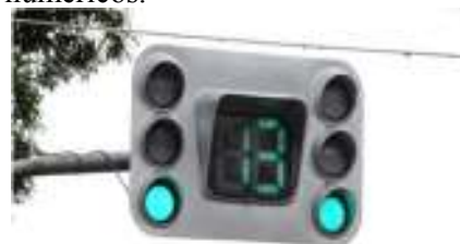
Figura 1. Semáforo Inteligente com Temporizador Numérico
